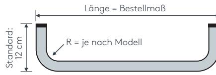
**Tipp:** Bei Aluschienen von Wand zu Wand ergibt sich die Länge = aMauerlichte abzüglich 1 cm Luft.
