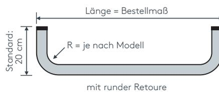
**Tipp:** Bei Aluschiene von Wand zu Wand ergibt sich die Länge = Mauerlichte abzüglich 1 cm Luft.
