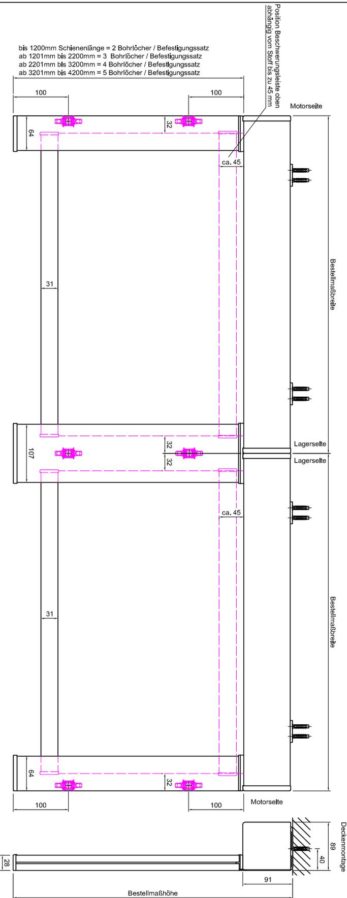
bis 1200mm Schienenlänge = 2 Bohrlöcher / Befestigungssatz
