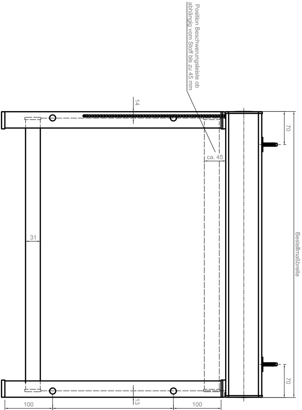
bis 1200mm Schienenlänge = 2 Bohrlöcher
