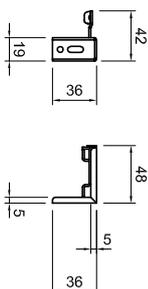
Detail Spannwinkel für Seilabspannung
