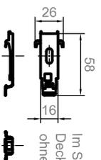
Im Standard mit Montageprofil und Decken-Wandclip 24.7548 - ohne Montageprofil mit Träger lose
