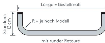
**Tipp:** Bei Aluschiene von Wand zu Wand ergibt sich die Länge = aMauerlichte abzüglich 1 cm Luft.
