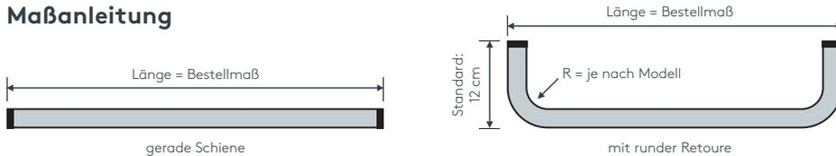
**Tipp:** Bei Aluschienen von Wand zu Wand ergibt sich die Länge = Mauerlichte abzüglich 1 cm Luft.
