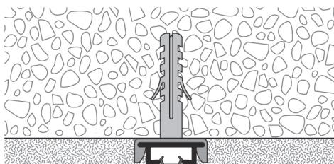
Unterlagsscheiben einläufig werden zum Ausgleich allfälliger Deckenunebenheiten mitgeliefert.
