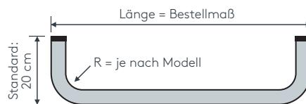
**Tipp:** Bei Aluschienen von Wand zu Wand ergibt sich die Länge = Mauerlänge abzüglich 1 cm Luft.
