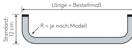
**Tipp:** Bei Aluschienen von Wand zu Wand ergibt sich die Länge = aMauerlichte abzüglich 1 cm Luft.
