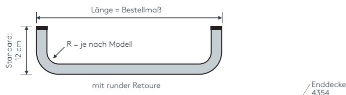
**Tipp:** Bei Aluschienen von Wand zu Wand ergibt sich die Länge = Mauerlänge abzüglich 1 cm Luft.
