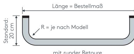
**Tipp:** Bei Aluschienen von Wand zu Wand ergibt sich die Länge = Mauerlänge abzüglich 1 cm Luft.
